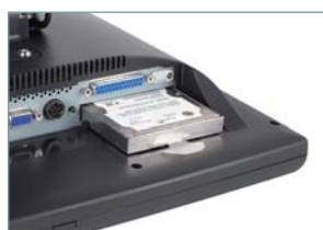
Простой доступ к жесткому диску для замены или профилактики.
