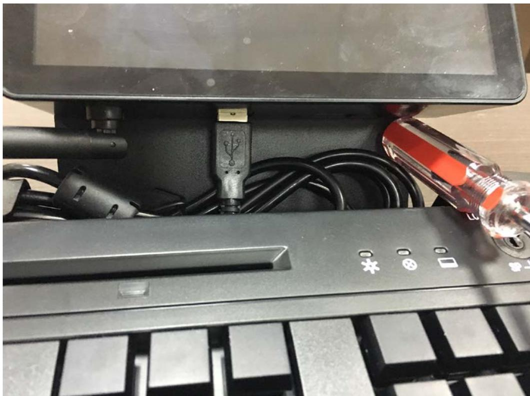
7. Возьмите 4 винта, выкрученных ранее из клавиатуры, и с помощью них прикрутите базовый терминал к кронштейну:
