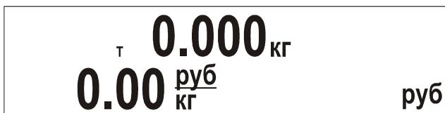
Если теперь снять тару с грузоприемной платформы, то на дисплее будет показан вес тары со знаком минус; указатели **Ноль** и **Тара** включатся.
