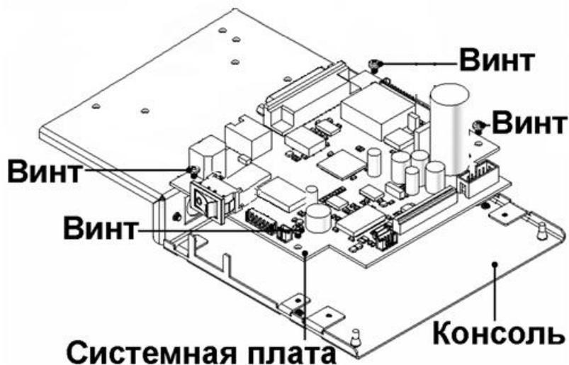
Рисунок 7 Отсоединение консоли системной платы
