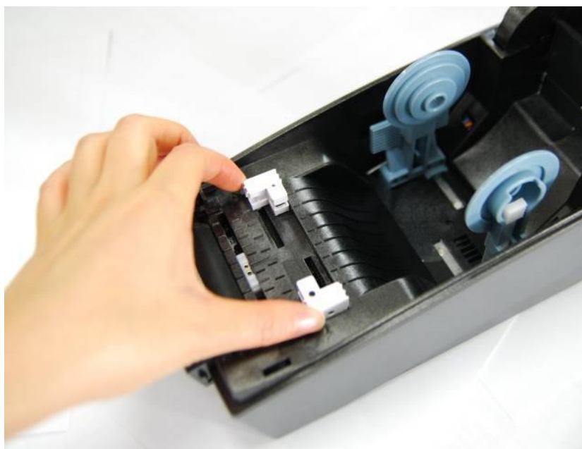
Передающий сенсор (контроль разрыва /конца ленты)
