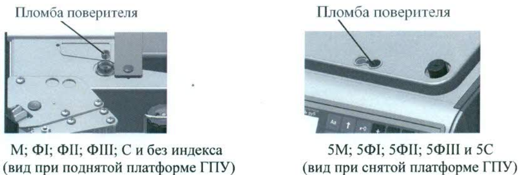
Рисунок 2 – Схемы пломбировки весов, обозначение места нанесения знака поверки (индексы: М; 5М; ФІ; 5ФІ; ФІІ; 5ФІІ; ФІІІ; 5ФІІІ; С; 5С и без индекса)
