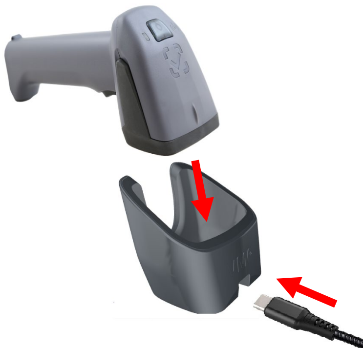
Рис. 6 Зарядка сканера через компактный кредл
