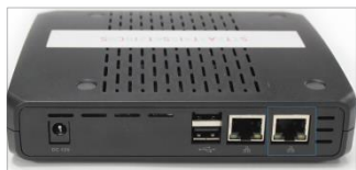
Рисунок 3 — разъем для подключения к сетевой карте
