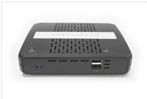
Рисунок 35 — кнопка для возврата к заводским настройкам
